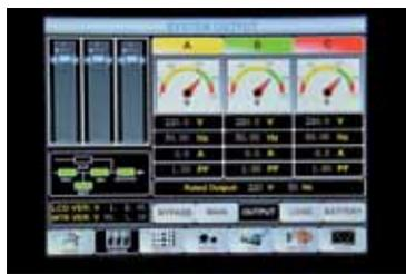
Parametri registrabili: allarmi, voltaggio, potenza di bypass, input e output.
